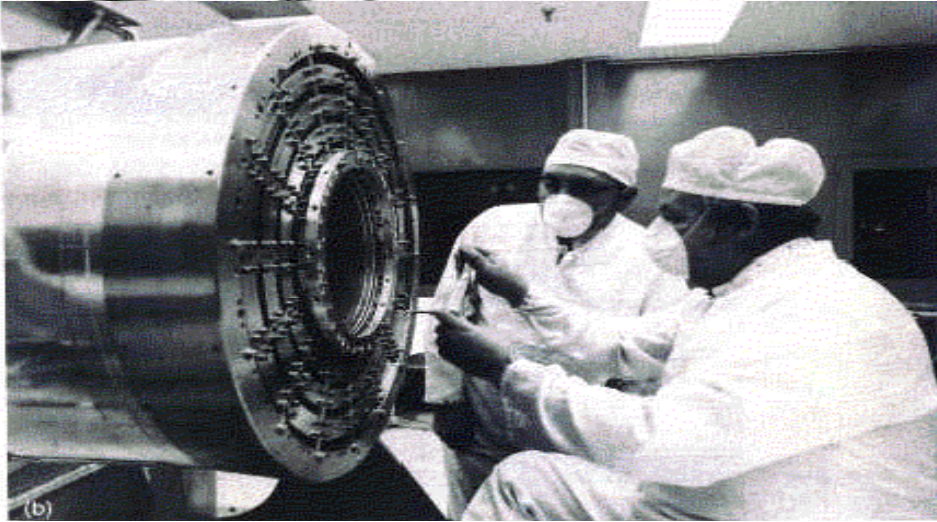
ışın görüntüsünün nasıl oluşturulabildikleri gösterilmiştir. Şekil-2.b: HEAO-2 Einstein X-ışın Gözlemevi'nde kullanılmak üzere kurulmuş aynalar gösterilmektedir.
